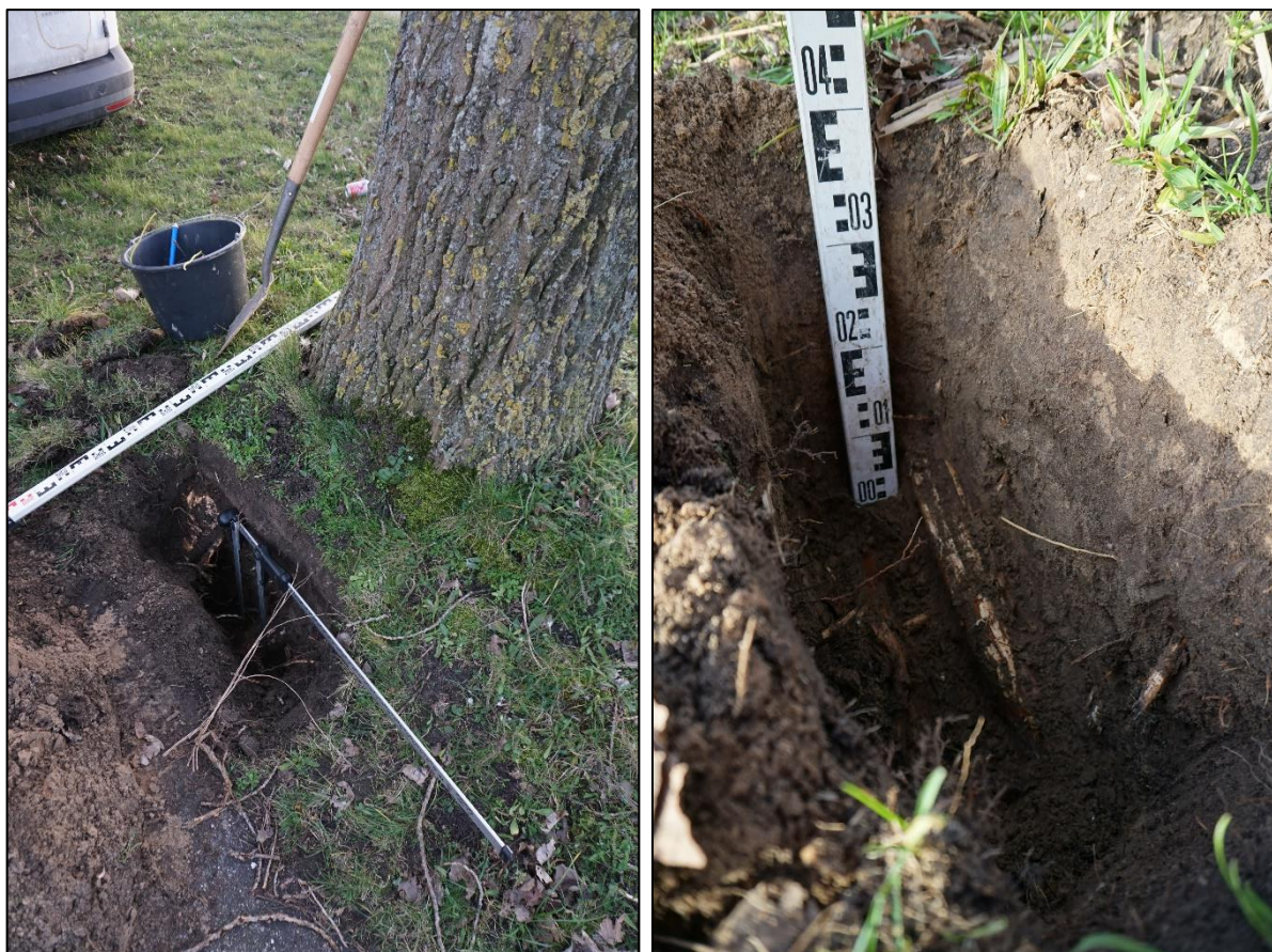
Foto 5 links: Impressie sterke verticale groei-richting van de beworteling bij boomnummer 17 in gebied A. Foto 6 rechts: Impressie beworteling bij boomnummer 34 in gebied A.
