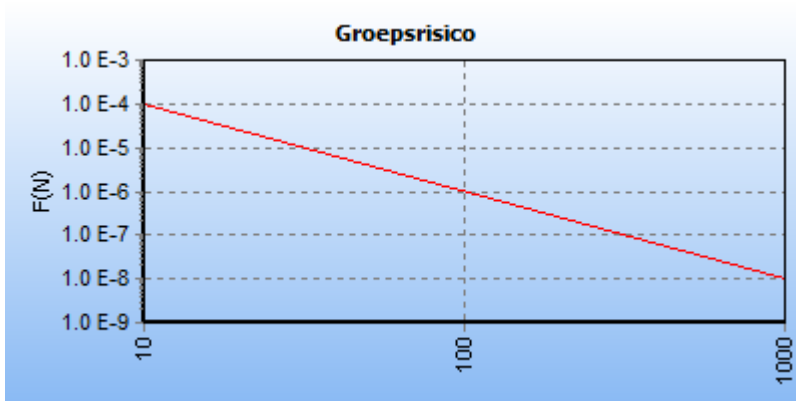
Figuur 5.18 FN curve A-807 van N.V. Nederlandse Gasunie voor de kilometer tussen stationing 17900.00 en stationing 18900.00
