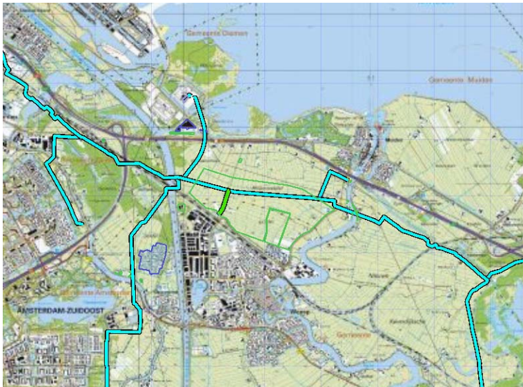
Figuur 5.26 Kilometer leiding behorende bij de maximale overschrijding van de FN-curve voor W-533-10 van N.V. Nederlandse Gasunie
