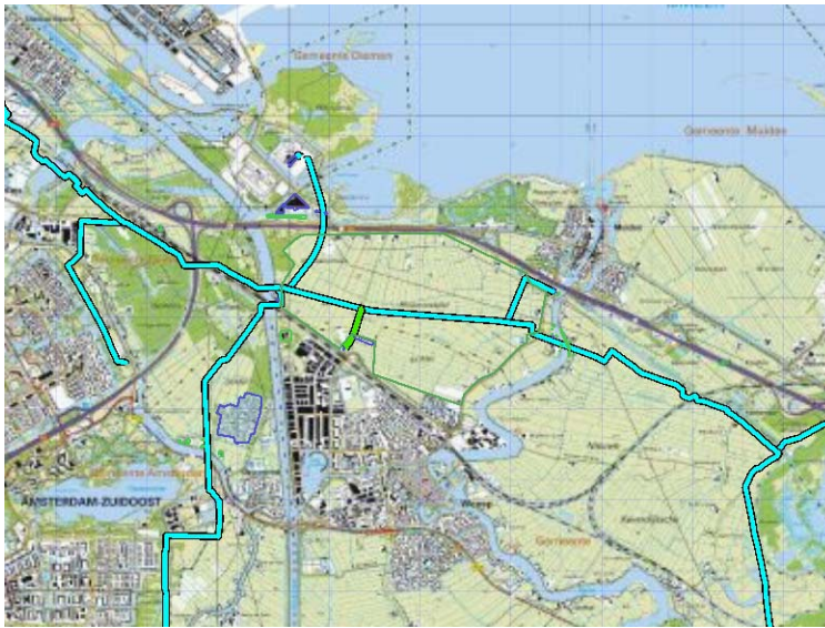
Figuur 5.11 Kilometer leiding behorende bij de maximale overschrijding van de FN-curve voor W-533-10 van N.V. Nederlandse Gasunie
