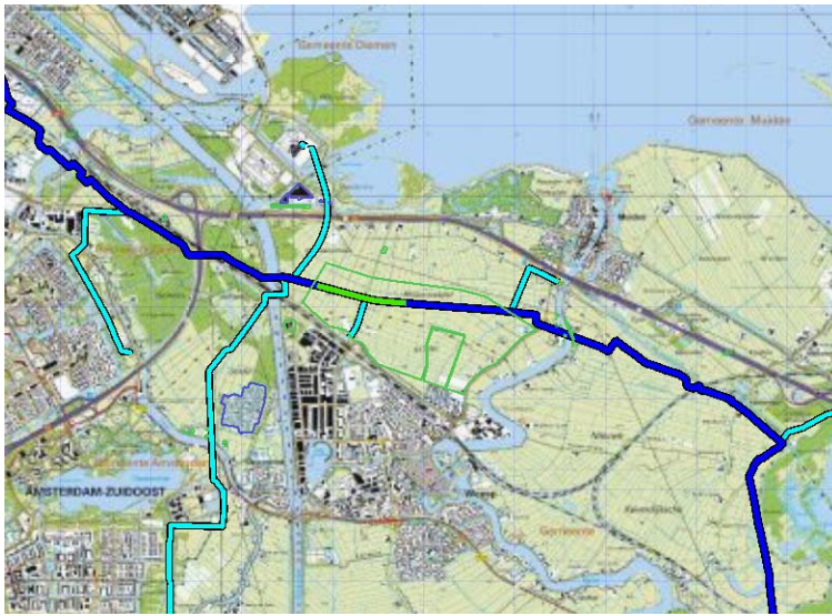
Figuur 5.23 Kilometer leiding behorende bij de maximale overschrijding van de FN-curve voor W-533-01 van N.V. Nederlandse Gasunie
